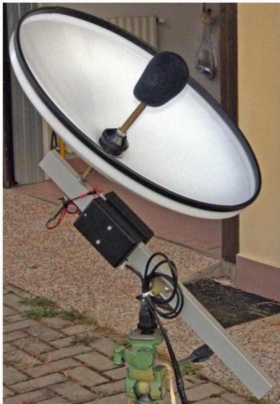
Il diffusore parabolico va forato al centro (evidenziato sulla stessa) con punte di diametro progressivo fino ad ottenere un foro di poco più di 1 cm.
