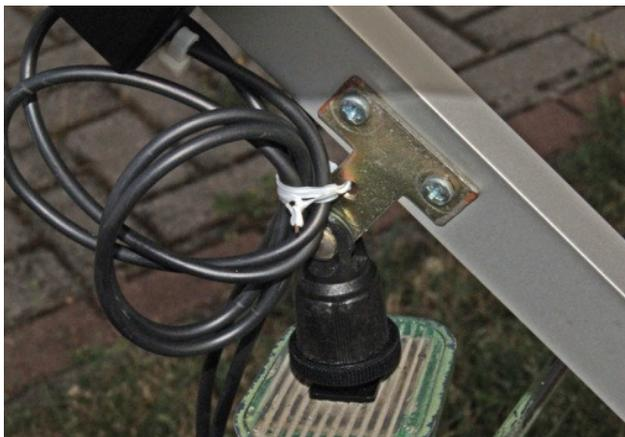
E' agevole aggiungere, usando una squadretta a "T", un supporto per microfono, in modo da potere poi usare una colonna di supporto per microfoni o un monopiede/treppiede fotografico.
