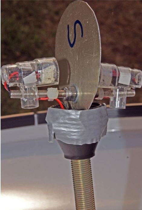
Occorre poi un portalampada a vite stretta "non passante" la parte avvitabile sarà il supporto del gruppo microfoni. Va tagliata a lama calda per quasi tutta la lunghezza (preservando ovviamente il filetto che lo fisserà al canotto filettato), per infilarvi un separatore di lamierino.
