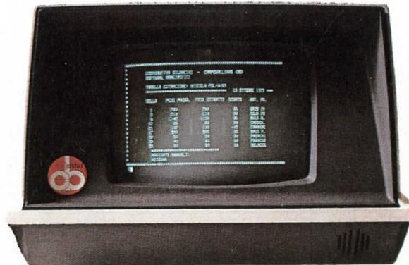
Gestione magazzino: Display della situazione « SILOS » materie prime.
